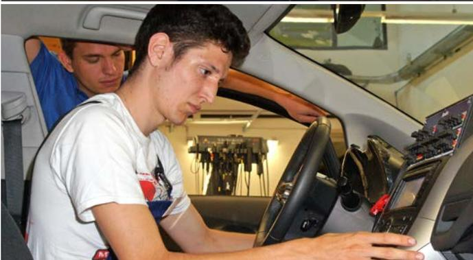
Raphael Tschümperlin (21 ans): « J'ai trouvé le poste 4 «suspension / direction» particulièrement ardu. Il fallait vérifier la suspension, remplacer les pièces défectueuses puis régler la géométrie. Après 90 minutes, j'avais tout juste terminé la partie mécanique. Je n'ai pas eu le temps de régler la géométrie. »
