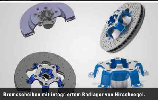
Bremsscheiben mit integriertem Radlager von Hirschvogel.
