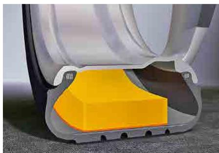
Beispiel für einen Reifen mit Silent-Technologie dank Polyurethanschaumstoff auf Polyetherbasis.
