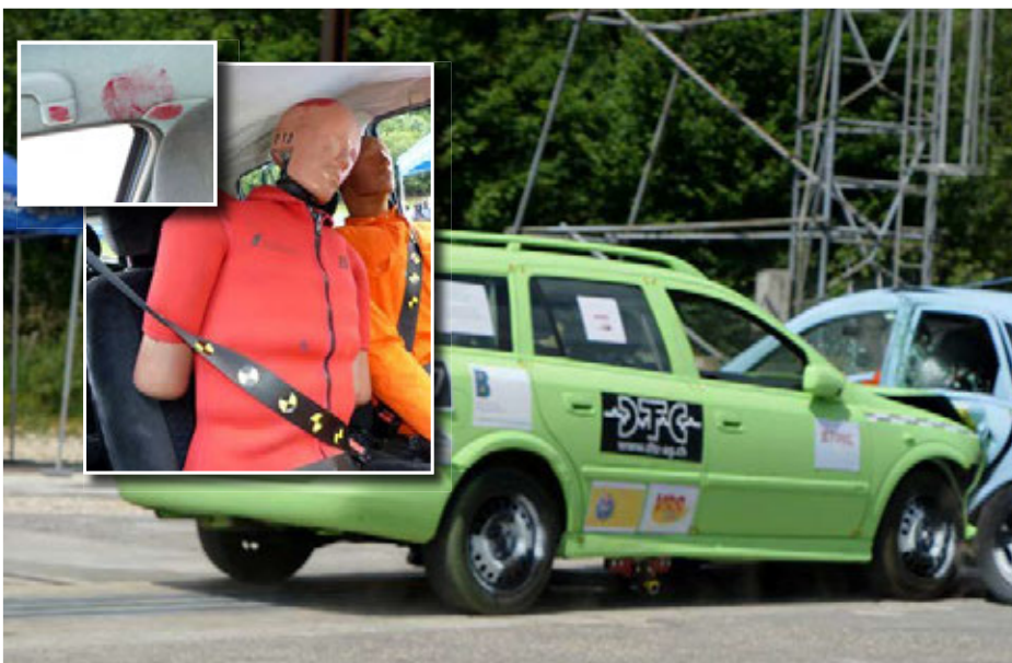
À 50 km/h contre un véhicule à l'arrêt. Lors du choc latéral, le passager glisse sous la ceinture de sécurité trois points. Les impacts de sa tête sur le toit et le montant B sont bien visibles.
