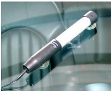
Illustration 4. La résine de finition se trouve entre la feuille et la zone réparée. Le rayonnement UV provoque le durcissement de la résine. La lampe UV est enclenchée pour une durée maximale de 10 minutes.
