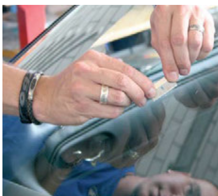
Illustration 5. Le surplus de résine est retiré avec précaution au moyen d'un grattoir à lame.
