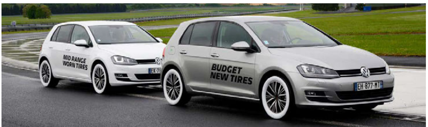
Procédure de test : afin de ne pas pouvoir identifier le type de pneu testé, les côtés des pneus ont été recouverts.
