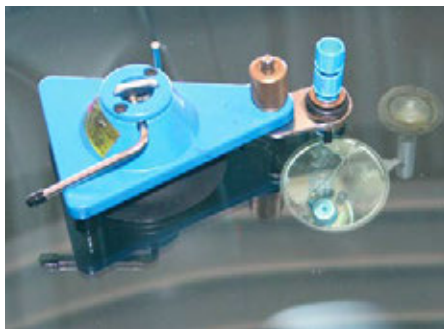
Illustration 3. Support avec injecteur. Le miroir installé à l'intérieur permet de mieux contrôler le remplissage de résine.
