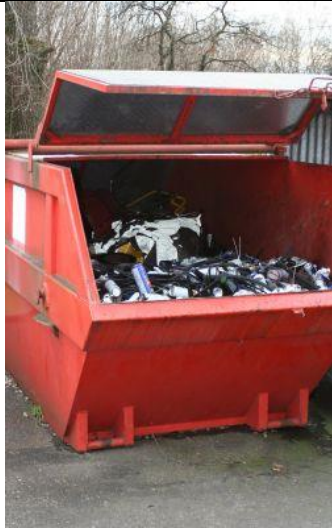
Abfallmulde gedeckt, dicht und auf befestigtem Boden.
